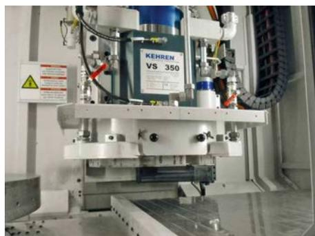
Abbrichtvorrichtung / KSS-Zuführung
